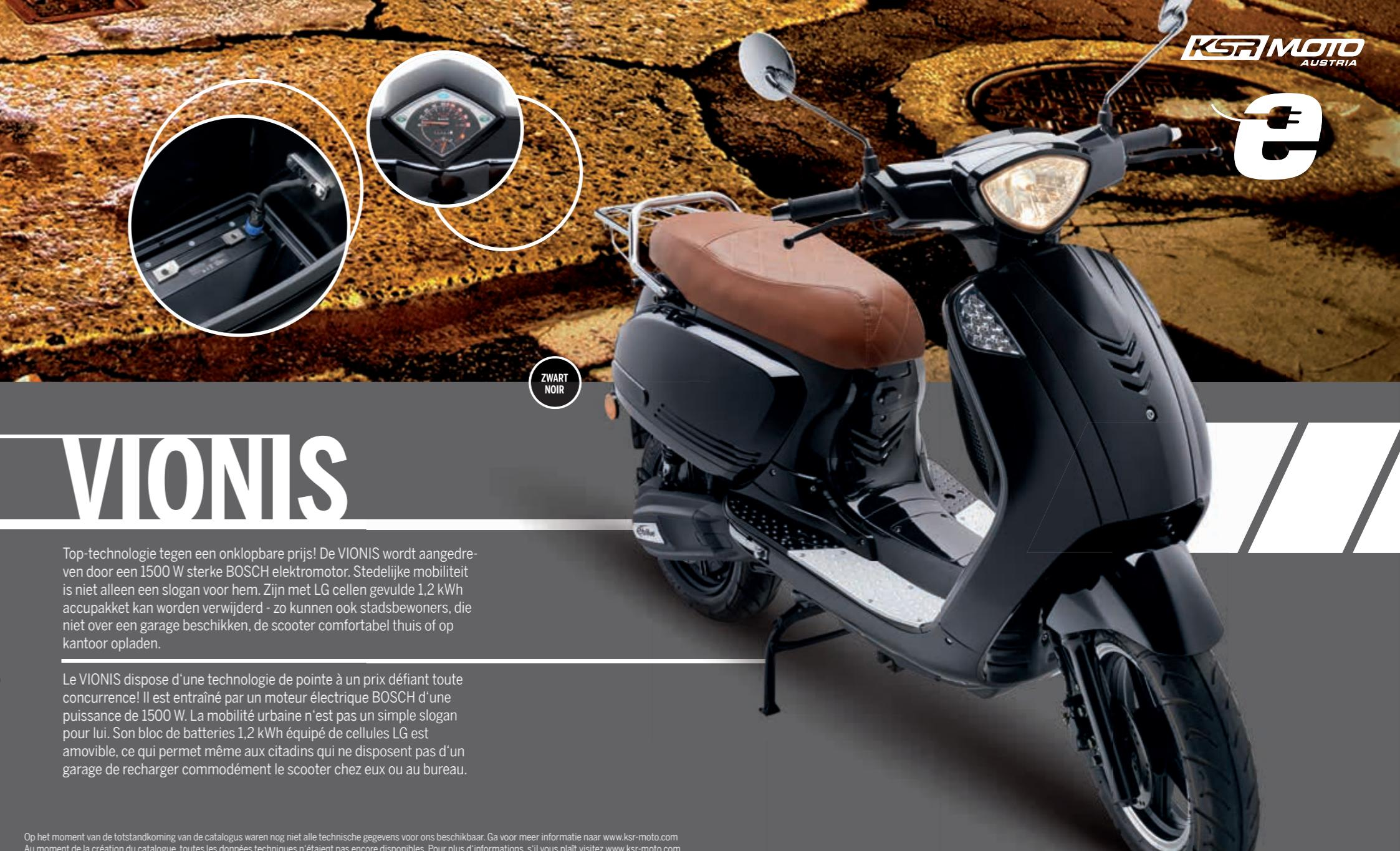
Top-technologie tegen een onklopbare prijs! De VIONIS wordt aangedreven door een 1500 W sterke BOSCH elektromotor. Stedelijke mobiliteit is niet alleen een slogan voor hem. Zijn met LG cellen gevulde 1,2 kWh accupakket kan worden verwijderd - zo kunnen ook stadsbewoners, die niet over een garage beschikken, de scooter comfortabel thuis of op kantoor opladen.
