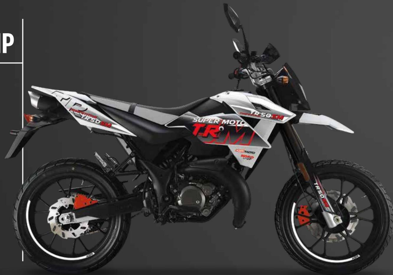
TIPO DE MOTOR: 2 T | CILINDRADA: 49,6 cm<sup>3</sup> | POTENCIA MÁX.: 2,3 kW@6500 rpm | PESO: ~113 kg | FRENOS: disco/disco
